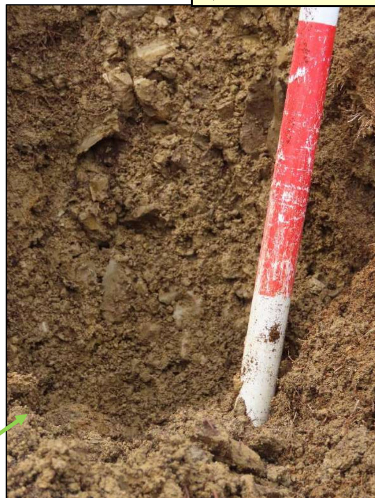
図8 崩壊源での露頭観察と柱状図作成 (2020.4.30撮影)
