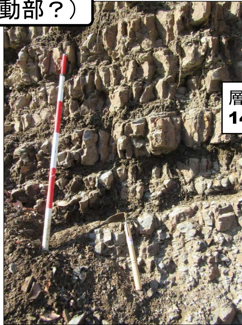
N 箇所(岩盤ブロック化・押し出し)
