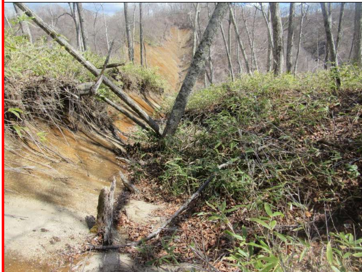
図18 D箇所の写真集1(崩壊地中央部の平坦～緩斜面に生じた亀裂とその断面) —2020.4.24撮影—
