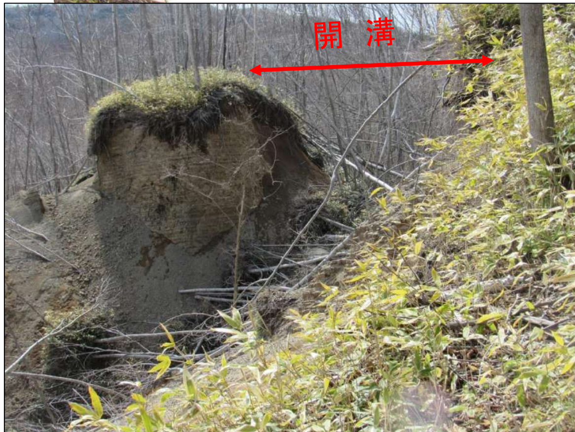
第14図 斜面最上部西寄りの岩盤分離箇所とその下位斜面の写真集(2020.4.24撮影)
