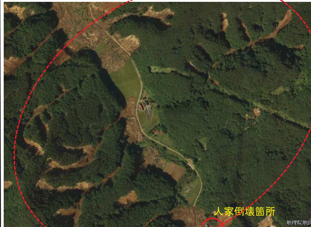
西岸側G崩壊・地すべり箇所: 平滑斜面の崩落型に近いもの、浅谷崩壊・地すべり型、沢収斂で沢口で狭まり低地で拡散型など様々なタイプが展開する。
