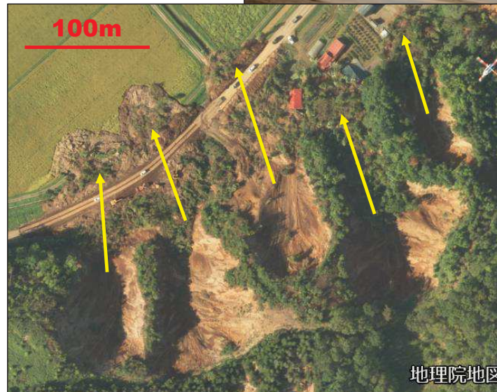
道路を塞ぎ水田に乗り出した地すべりの崩壊箇所(前ページ空中写真の地点5)。溝は災害後に排水のために掘削された。溝断面は本箇所付近が泥炭地であることを示す。
