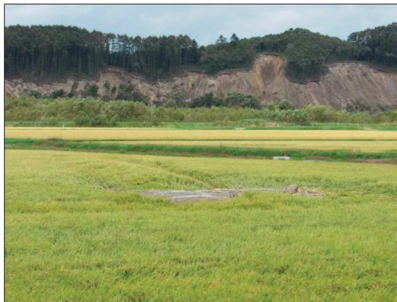
地点4 Bの噴砂部。前方は吉野地区の崩壊箇所。
