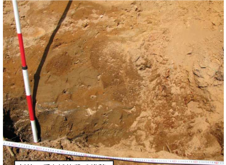
新第三系と低位段丘堆積物の境界部の拡大写真
