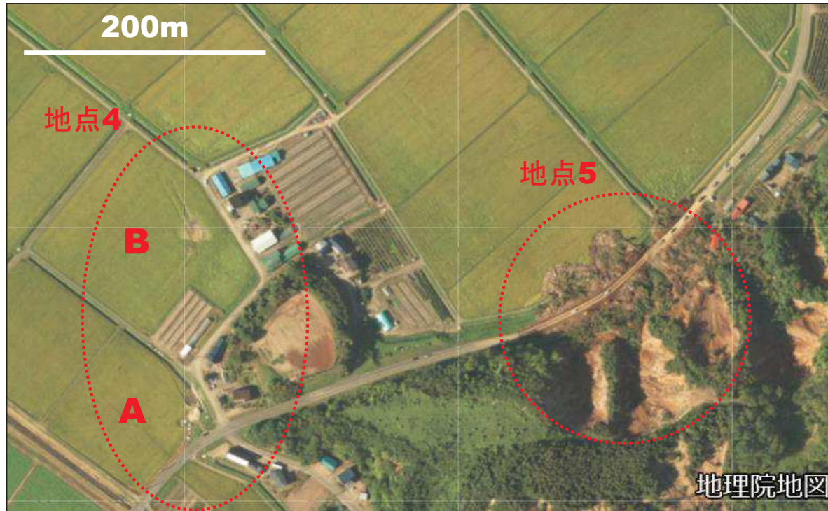
東と北東部の拡大空中写真(国土地理院2018.9.6撮影空中写真「厚真川地区」の一部使用)。 地点4は埋設管に沿うジグザグの変状とコーナー部で噴砂が発生したことが分かる。
