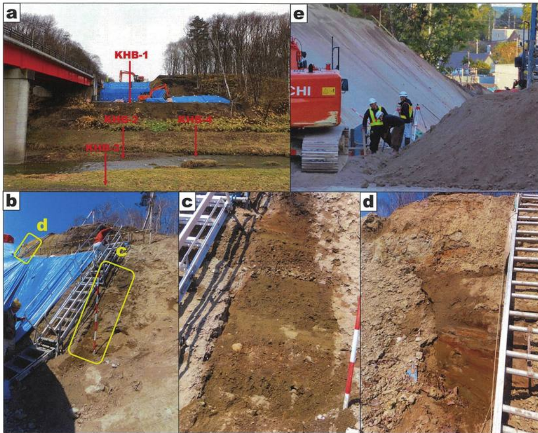
第5図 北進橋北西端の河崖露頭L1(切土)。a:北進橋調査ボーリング箇所(北西へ向かって撮影), b:露頭全容, c:露頭下部(砂礫部), d:露頭上部(上へ葉理ある細～中粒砂, 含礫砂質泥), e:橋西側の切土露頭(支笏火山噴出物Spfl)。bの下端はテラス状を成し, KHB-1孔の孔口レベルに該当。
