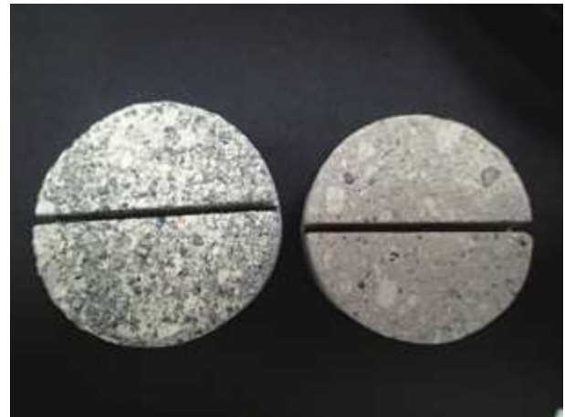
第9図 札幌軟石(右)と小樽軟石(左)の比較。ボーリングコアの断面(直径5 cm)。
