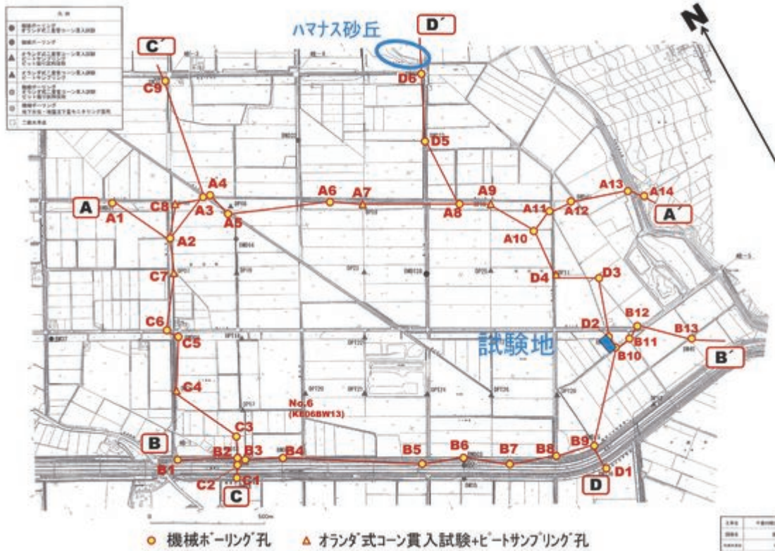
第3図 舞鶴遊水地とその周囲の断面解析位置図 (平成18年度千歳川右岸地区地質調査業務の調査位置平面図 1/5,000 使用).
