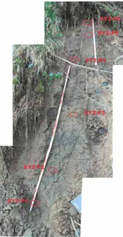
第8図 YB-2地点のI柱状図作成部分。赤丸印は花粉分析に供した試料採取部(SY2-P1～6)。
