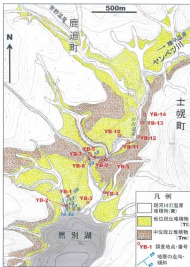
第3図：ヤンベツ川下流域の段丘面区分とその堆積物の分布。調査地点の位置を強調して示す。
