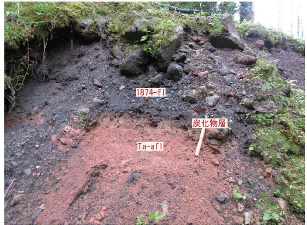
図5 Ta-af1 に累重する 1874fl。写真上端の草の生えた所が微高地の尾根をなしている。2016年6月18日撮影。
