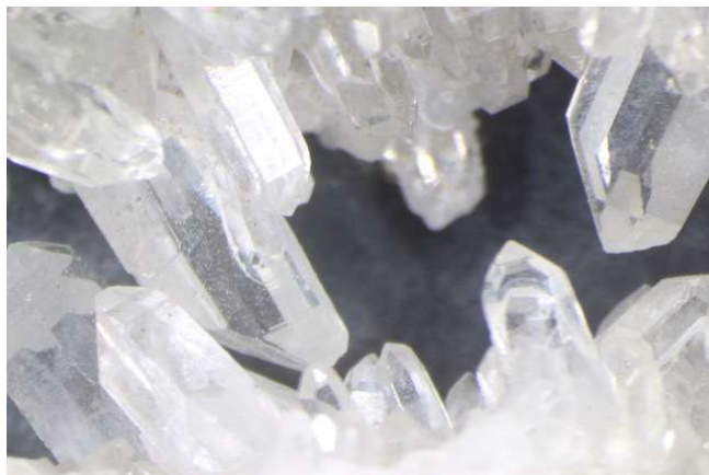
地熱井から採取されたスポットコア中の開口亀裂の壁面から成長する自形石英。写真の長辺がおおよそ12.5mm
