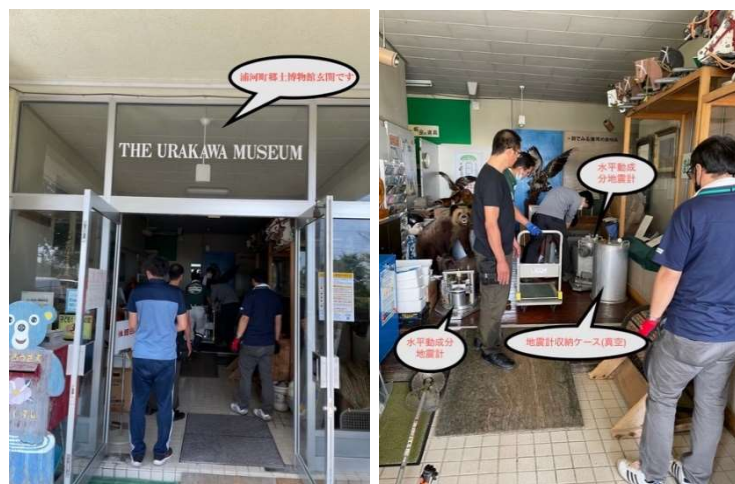
図1 浦河町立郷土博物館での広帯域高感度地震計搬入作業
