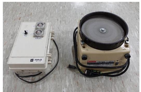
図1: 包丁磨き機改造の研磨機(右)と電気の入り切りタイマー(左)
